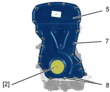
Déposer sur la périphérie du carter de distribution (5) un cordon d'étanchéité indice "E10".
