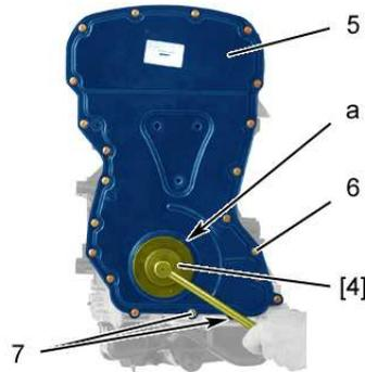
Effectuer **1/4 de tour** dans le sens antihoraire et déverrouiller la bague d'étanchéité (en "a") à l'aide de l'outil [4].
